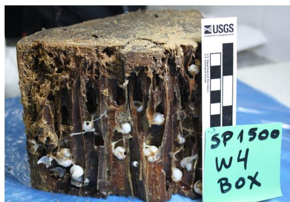
Figura 5: amostra de SP\_1500 cortada em ¼ com suas galerias perfuradas por *Xylophaga sp.*
